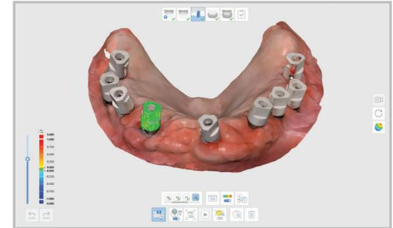
Los pilares y los cuerpos de escaneo se alinean de forma automática con la información del escaneo. Utilice esta función para trabajos subsiguientes como el CAD.
