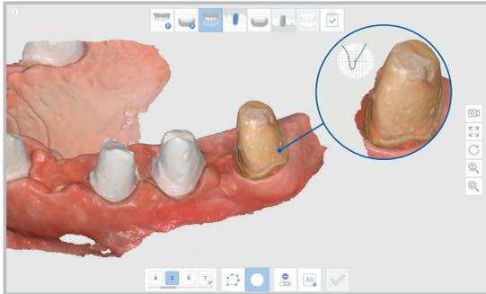
Elija entre permitir que el sistema genere automáticamente la línea de margen para cualquier diente o crearla manualmente.
